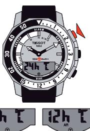
При переходе из режима 24-часовой индикации в режим 12-часовой индикации под цифровым указателем времени появляется обозначение AM (до полудня) или PM (после полудня)
