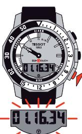
а) Остановка мигания индикатора, отображение промежуточного времени, работа хронографа в фоновом режиме
