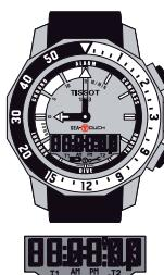
Контроль цифрового индикатора – стрелки установлены в нулевое положение для измерения глубины и скорости погружения
