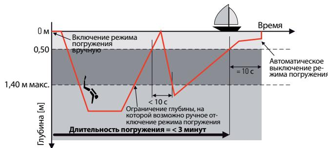
Если погружение длится менее 3 минут, режим погружения автоматически выключается, когда дайвер находится на поверхности более 10 секунд.
