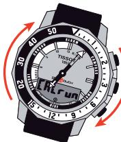
Поверните компас более чем на один оборот на горизонтальной поверхности (например на столе) в помещении без магнитных возмущений со скоростью вращения около 30° в секунду.
