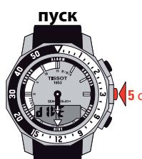
Включение режима погружения вручную
