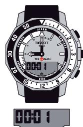
Режим погружения включен – Время погружения отображается на цифровом индикаторе, минутная стрелка указывает на ободке глубину погружения в метрах или футах, часовая стрелка указывает на циферблате скорость погружения в м/мин или футах/мин
