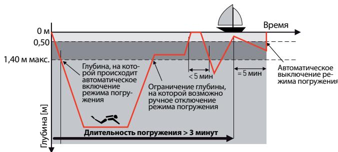
Если погружение длится более 3 минут, режим погружения автоматически выключается, когда дайвер находится на поверхности более 5 минут. Данные, измеренные при погружении, заносятся в память.
