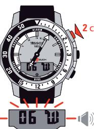
Режим настройки и индикация магнитного склонения
