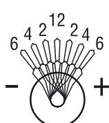
Для определения погодных условий механизм часов T-TOUCH учитывает изменения атмосферного давления в течение последних 6 часов. Помимо этого часы регистрируют резкое изменение давления, связанное с изменением высоты, и автоматически компенсируют его. Вследствие чего это изменение оказывает минимальное воздействие на прогноз барометра.
