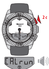
Включение режима калибровки: - сенсорное стекло во время калибровки неактивно.
