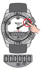
Коснитесь стекла дважды, чтобы вывести на дисплей сохраненное промежуточное время.
