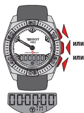
Отключение звонка осуществляют- ся нажатием любой кнопки.
