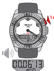
Запуск функции SPLIT хронографа осуществляется кнопкой ⊕
