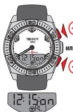
+ и - : установка времени сигнала
